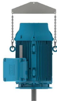
Figura 4.8 - Izamiento de motores verticales.
