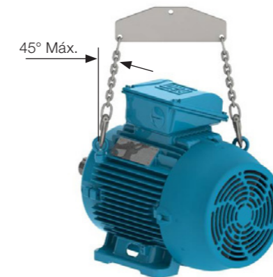
Figura 4.4 – Ángulo máximo resultante para motores con dos o más ojales de izamiento.
